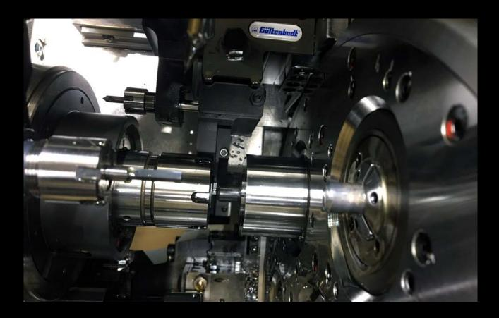
Le nouveau système de tronçonnage G80A est équipé en série de l'arrosage interne pour assurer une grande performance d'usinage en toutes conditions. Les largeurs de tronçonnage de 1.5 ou 2 mm assurent un tronçonnage économique en minimisant les pertes de matière.
